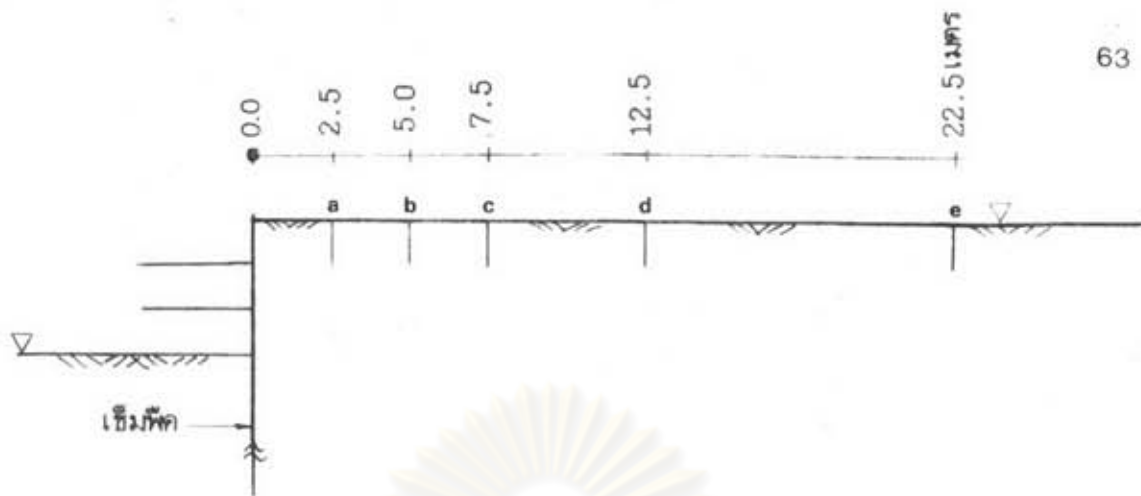
รูปที่ 3.12 ลักษณะการติดตั้งหมุดวัดการทรุดตัวที่ผิวดิน (Settlement Points) ของแนวทดสอบตามขวาง (Test Sections) ใด ๆ.
