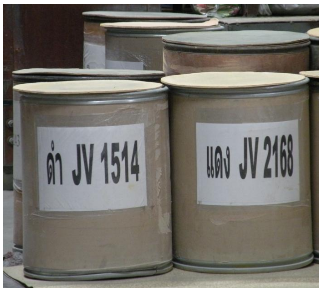
ภาพที่ 3.5 ถังบรรจุสีผง หนึ่งในวัตถุดิบหลักของการขึ้นรูปพีวีซี
