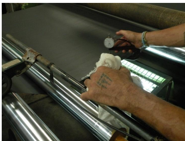
ภาพที่ 4.4 การตรวจสอบความหนาของงานผลิตระหว่างดำเนินงานผลิต
