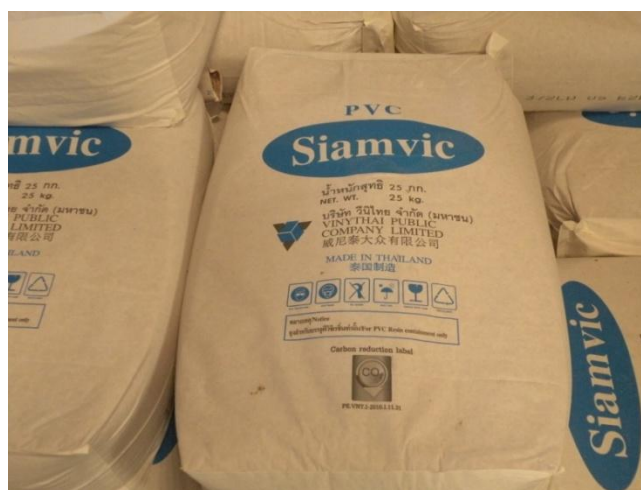
ภาพที่ 3.4 พีวีซีเรซินที่ใช้เป็นวัตถุดิบหลักของการรีดพีวีซี
