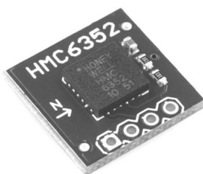
ภาพที่ 3.4 เซนเซอร์เข็มทิศ รุ่น HMC 6352
