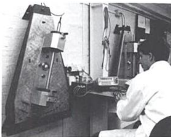
ภาพที่ 2.5 หลักการสอบเทียบหัวอ่าน (Dunnicliff, 1993)
