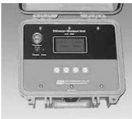
ภาพที่ 2.2 อุปกรณ์อ่านสัญญาณ (Readout Unit) ของบริษัท Slopeindicator
