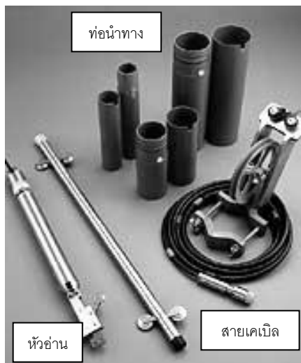
ภาพที่ 2.1 มาตรฐานวัดการเคลื่อนตัวแนวราบ (Inclinometer) ของบริษัท Slopeindicator
