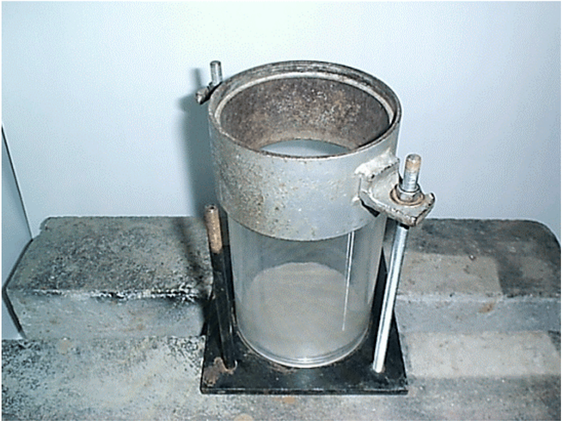
รูปที่ 3.10 แสดงรูปชุดกระบอกตัวอย่างสำหรับการบดอัด
