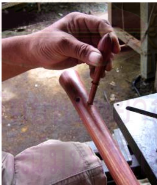
ภาพที่ 2. 86 ประกอบลูกบิดเข้ากับคันทวน
