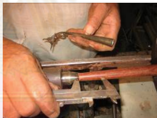
ภาพที่ 2. 41 วัดขนาดคันทวนที่จะสวมหัวเป็ยะ
