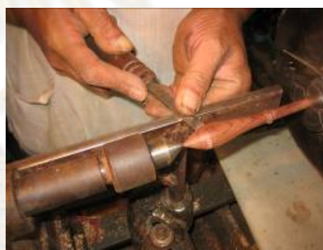
ภาพที่ 2. 50 กลึงลูกบิดที่ 2
