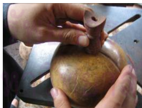
ภาพที่ 2. 72 เตรียมติดกับคันทวน
