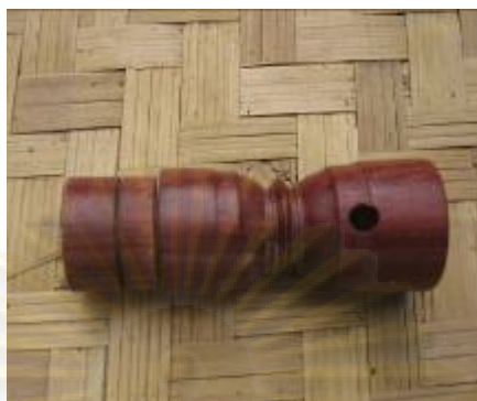
ภาพที่ 2. 68 ช้อนต๋อที่กลึงและเจาะเสร็จ
