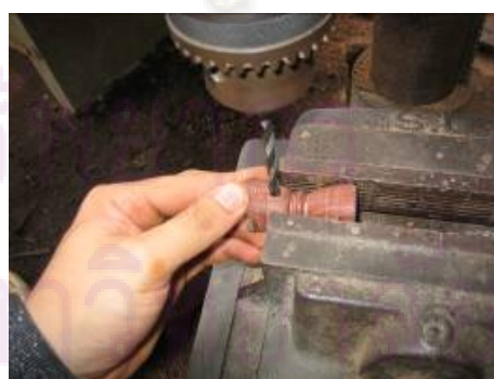
ภาพที่ 2. 67 เจาะรูข้อต่อด้านข้าง
