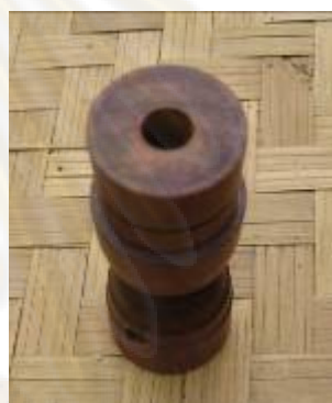
ภาพที่ 2. 68 ช้อนต๋อที่กลึงและเจาะเสร็จ
