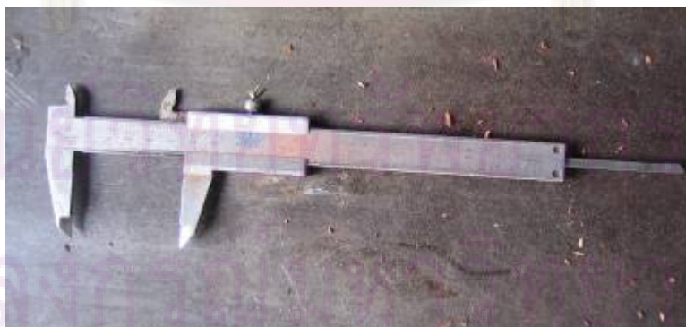
ภาพเครื่องมือวัดขนาดหรือVernier Calipers
