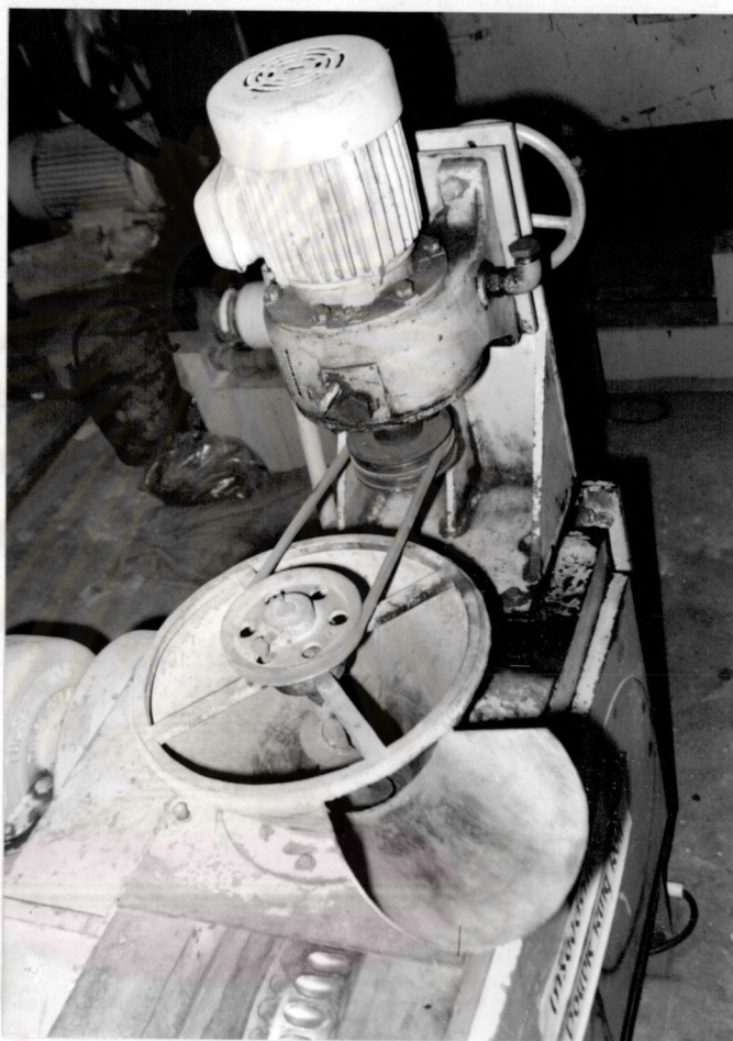
รูปที่ 3.6 Screw feeder ของเครื่องอัดก้อนแบบ Double Ring Roll
