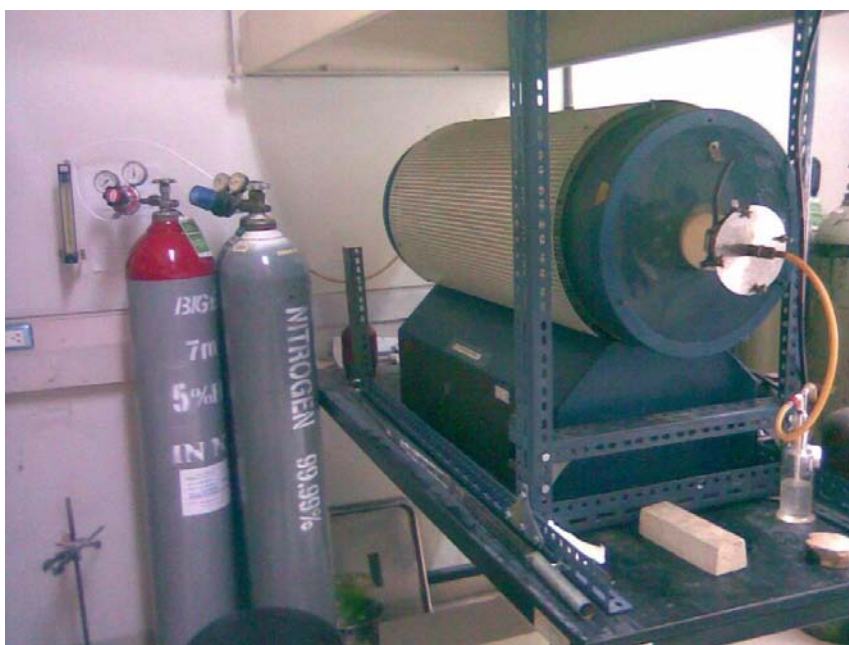
รูปที่ 3.2 เตาท่ออะลูมินา (tube furnace: Lenton furnace 1500°C)
