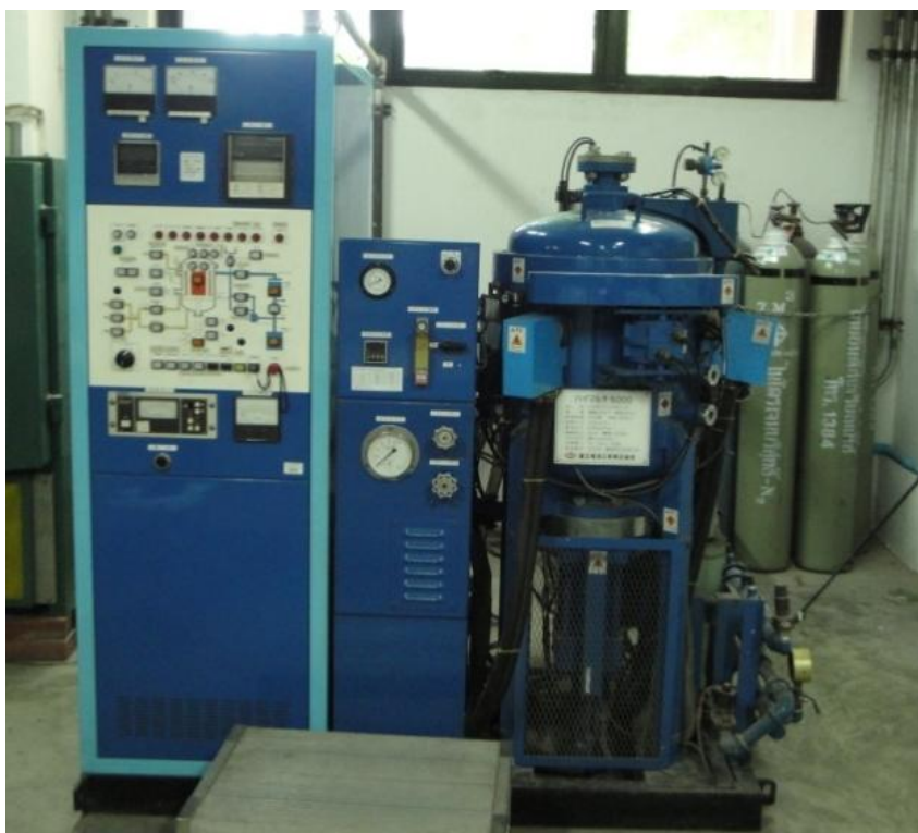
รูปที่ 3.4 เตาเผาควบคุมบรรยากาศ (Hi-Multi 5000, FV PHP-R-5, FRET-25)
