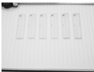
ภาพที่ 3.13 ชิ้นงานที่นำไปทดสอบสมบัติการทนต่อแรงกระแทก
