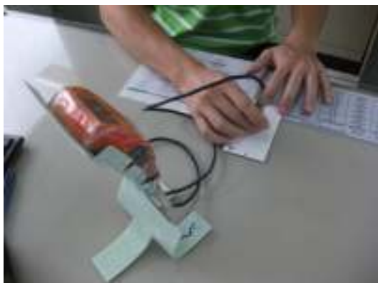
รูปที่ 6.4 การทดสอบการวัดความหนาของฟิล์มสีบนแผ่นฟิล์มตัวอย่าง
