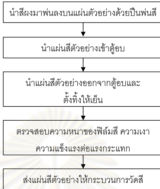
รูปที่ 4.8 ขั้นตอนการเตรียมแผ่นสีตัวอย่าง
