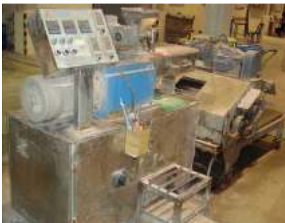
รูปที่ 4.6 กระบวนการฉีดด้วยเครื่องฉีดขนาดเล็ก
