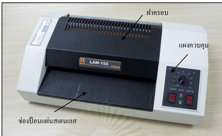
รูปที่ ข.2 เครื่องรีดฟิล์มไวแสง รุ่น LAM-150
