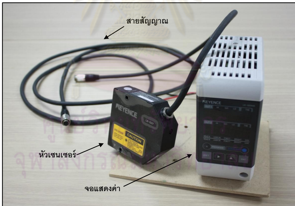
รูปที่ 3.2 เครื่องมือวัด Laser displacement sensor
