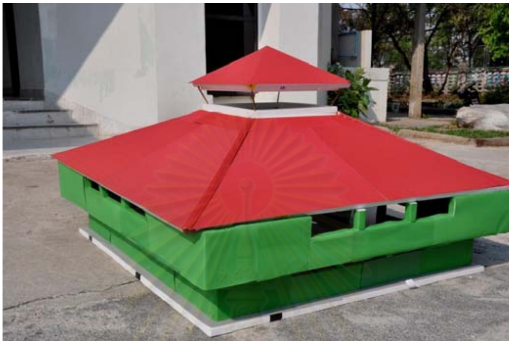
ภาพที่ 4.13 หุ่นจำลองขนาด 1:20 ที่ใช้ในการทดสอบผิวและสีของการสะท้อนแสง
