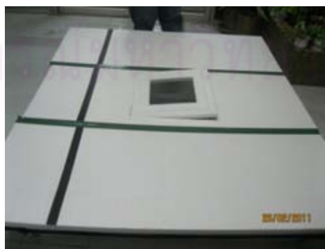
ภาพที่ 3.2 ภาพหุ่นจำลองแบบที่ 1 ที่ใช้ข้อมูลขนาดพื้นที่ของช่องเปิดด้านบนต่อพื้นที่ใช้สอยที่เหมาะสมในการวิจัยครั้งนี้
