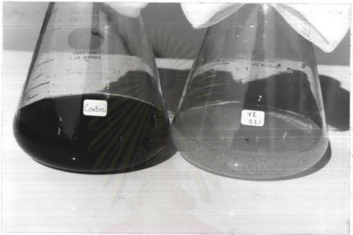
รูปที่ 35 แสดงภาพถ่ายผลการฟอกสีน้ำจากสาหร่ายพิษ D-1 ในขวด เลียงเชื้อ ซ้ำเป็นอาหารเลียงเชื้อ MPM ที่ยังไม่ได้ทำการฟอกสี ส่วนขวาเป็นอาหารเลียงเชื้อ MPM ที่ทำการฟอกสีด้วยราสายพันธุ์ D-1 แล้ว
