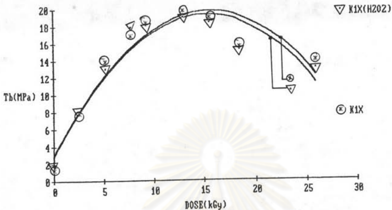
รูปที่ 5.64 แสดงความสัมพันธ์ระหว่าง Tb กับปริมาณรังสีของสารไวปฏิกิริยา 2EHA:CCl 4 และ H 2 O 2
