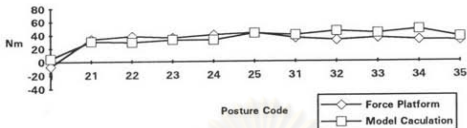
รูปที่ 6.7 ค่าโมเมนต์ที่เท้าที่ได้จาก Force Platform เปรียบเทียบกับค่าที่ได้จากแบบจำลองของผู้ทดสอบเพศชายคนที่ 2
