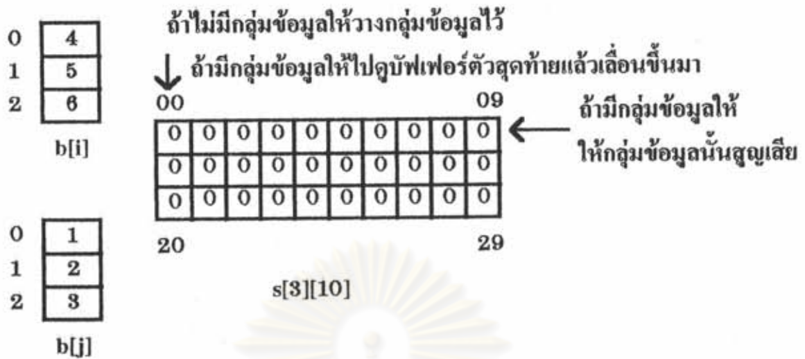
รูป 3.14 แสดงวิธีการจัดเรียงกลุ่มข้อมูลที่มีสิทธิ์ก่อนและไม่มีสิทธิ์ก่อน
