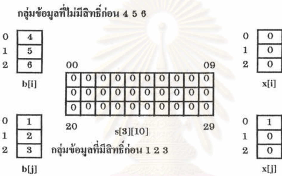
รูป 3.13 แสดงพื้นที่และกลุ่มข้อมูลของ b[i], b[j], x[i], x[j] และ s[3][10]
