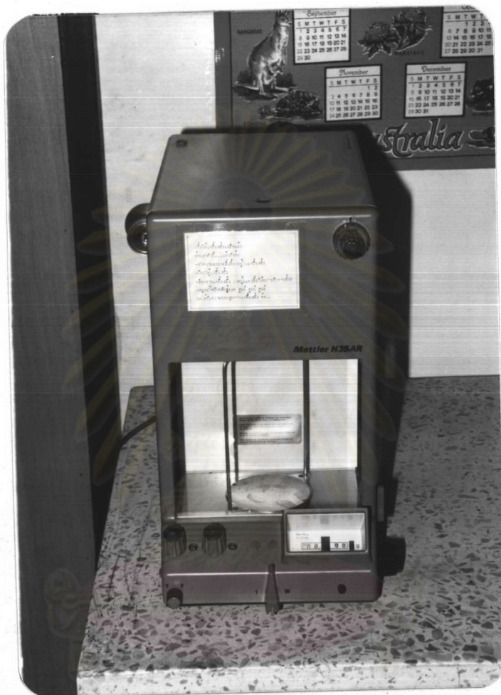
รูป 3.3 เครื่องชั่งไฟฟ้า 4 ตำแหน่ง จุฬาลงกรณ์มหาวิทยาลัย
