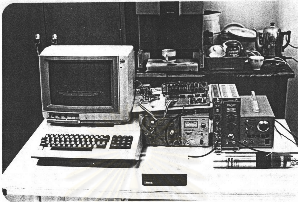
รูป 5.16 ชุดอุปกรณ์วิเคราะห์ความสูงของพัลส์แบบหลายช่องโดยใช้ไมโครคอมพิวเตอร์ชนิด 8 บิต ของแอปเปิล
