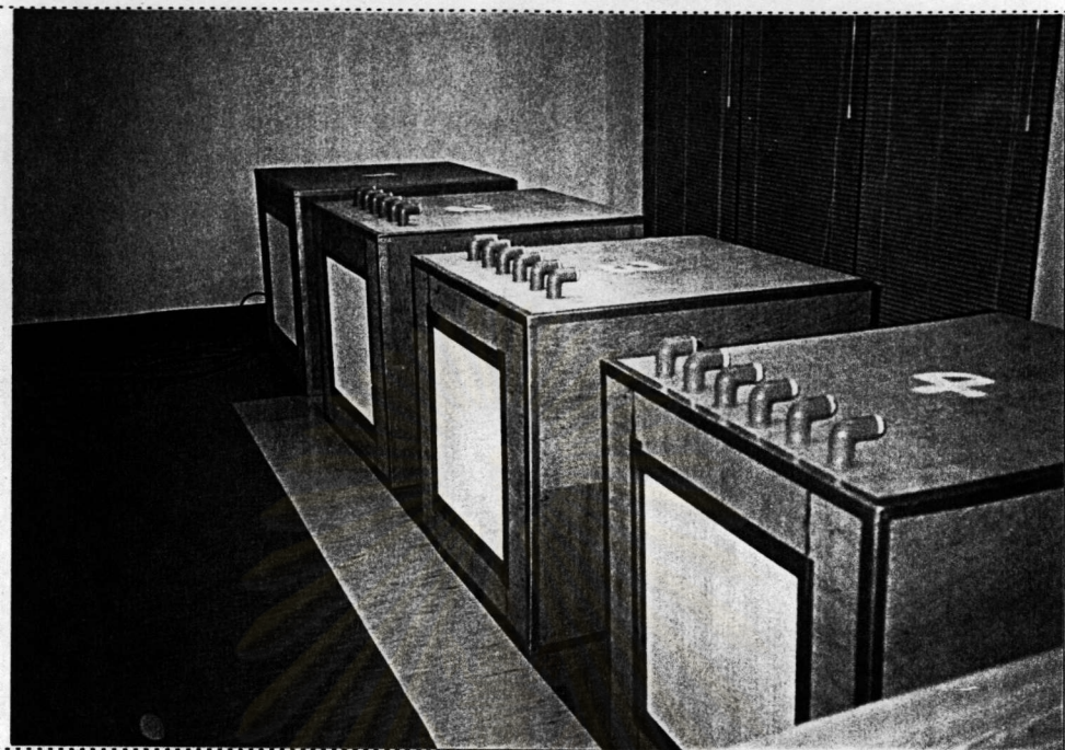
รูปที่ 9 แสดงด้านหน้าของกล่องทดสอบทั้ง 4 กล่อง ปิดด้วยโฟม 1-1/2 นิ้ว ทั้ง 4 กล่อง ตั้งภายในห้องปรับอากาศ เพื่อทำการ Calibrate คุณสมบัติของกล่องทดสอบ
