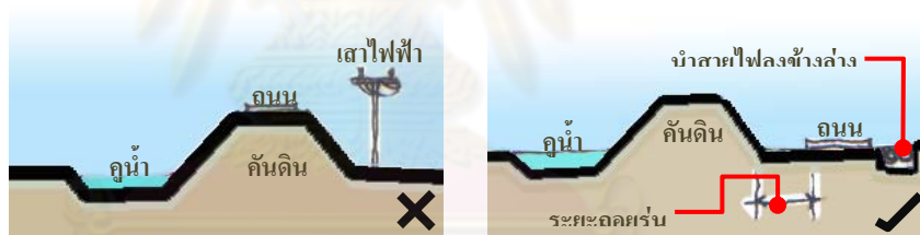
ภาพที่ 2.16 แนวทางการอนุรักษ์องค์ประกอบของชุมชนโบราณ โดยการกำหนดเส้นทางสัญจรให้ห่างจากขอบคันดินโบราณ
