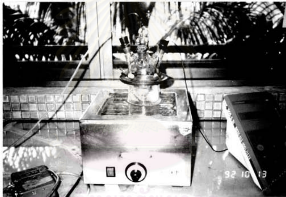
ศูนย์วิทยาศาสตร์ยากร จุฬาลงกรณ์มหาวิทยาลัย รูปที่ 3.1 Reaction Vessel ในการทดสอบกระบวนการเฟลอร์ไรท์
