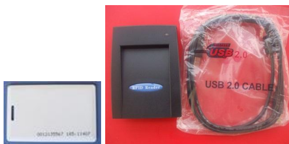
ภาพที่ 7.10 ตัวอย่างป้ายอาร์เอฟไอดีและเครื่องอ่านที่ใช้ในกระบวนการพัฒนาระบบ
