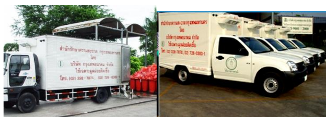
ภาพที่ 4.2 (ซ้าย)รถขนขยะติดเชื้อขนาดบรรจุ 2 ตัน (ขวา) รถขนขยะติดเชื้อขนาดบรรจุ 1 ตัน
