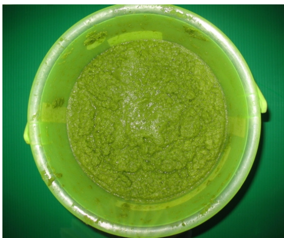
รูปที่ 4.2 ลักษณะของขยะสังเคราะห์ที่ผ่านการเตรียมที่ใช้ในการทดลอง
