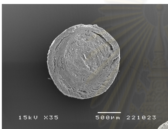
ค) ภาพถ่ายจากกล้องจุลทรรศน์อิเล็กตรอนแสดงลักษณะเม็ดตะกอนจุลินทรีย์เมื่อผ่ากึ่งกลางตามแนวขวางที่กำลังขยาย 35 เท่า
