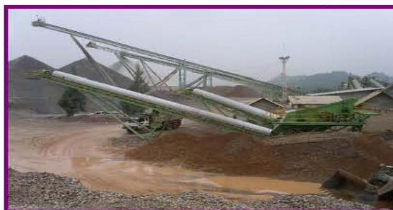
รูปที่ 5.2 ตะแกรงคัดแยกหินคลุกที่ PLANT CFBK (T5)
