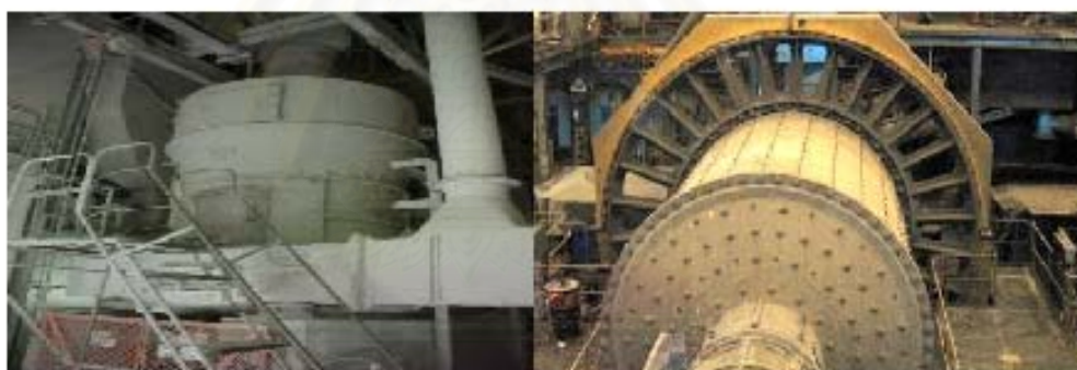
รูปที่ 3.17 Ball Mill / separator
