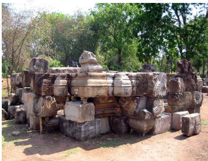
รูป 3-61 ถึง 3-63 การทดลองจัดเรียงหินแต่ละชั้นเพื่อทำ shop drawing หินชั้นบนขึ้นไปที่มีขนาดเล็กในเบื้องต้นได้ทดลองประกอบเป็นชุด
