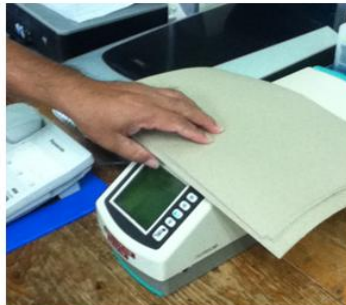
ตัดกระดาษให้มีขนาดเท่ากับกระดาษ A4 นำไปวัดค่าความขาว
