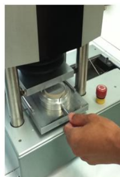
วัดค่ารับแรงกดแนววงแหวน ด้วยเครื่อง L&W Crush Tester
