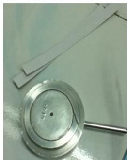
นำกระดาษที่ผ่านการตัด ไปใส่อุปกรณ์ สำหรับรับแรงกดแนววงแหวน
