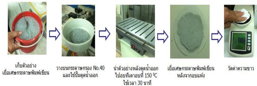
รูปที่ 4.9 เก็บตัวอย่างเยื่อเศษกระดาษพิมพ์เขียน และตรวจวัดความขาว
