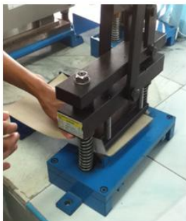
เก็บตัวอย่างตลอดหน้ากว้างของ ม้วนกระดาษ ตัดกระดาษขนาด 1.5 x 15.2 cm จำนวน 10 แผ่น
