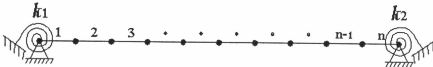
รูปที่ 2.13 รูปแบบการแบ่งเอลิเมนต์ของแบบจำลองสะพาน
