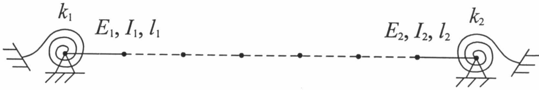
รูปที่ 2.12 ชิ้นส่วนคานที่มีจุดรองรับข้างหนึ่งเป็นข้อหมุนสปริง
