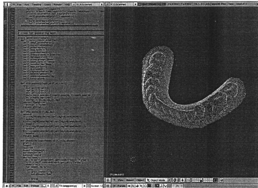
รูปที่ 5.2 ข้อมูลจุดของผิวฟันปลอมที่ได้จากเครื่องมือวัดพิกัดแบบใช้อินเตอร์เฟียร์โรเมตริกซ์
