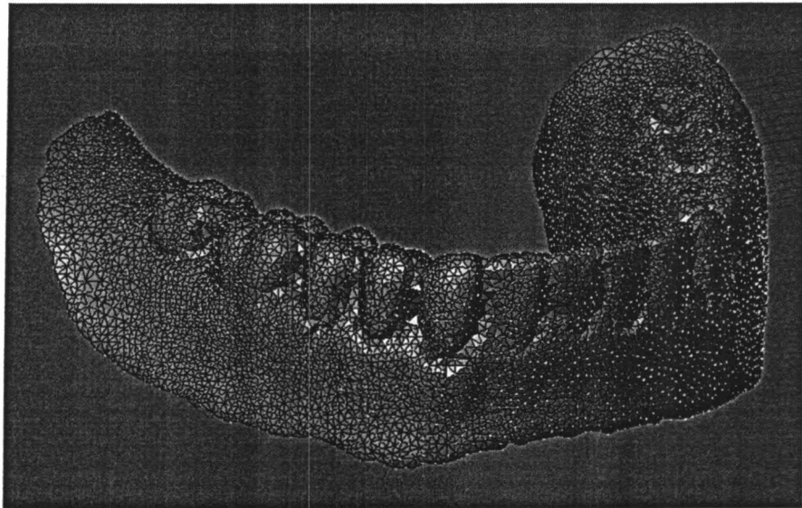
รูปที่ 5.28 ภาพแบบจำลองผิวตาข่ายสามเหลี่ยมของชิ้นงานฟันปลอม
