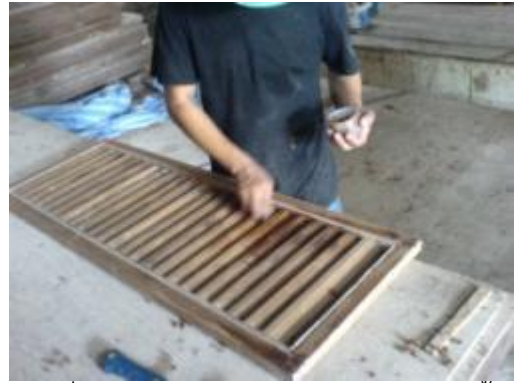
ภาพที่ ช.30 การแสดงอุดช่องว่างระหว่างชิ้นไม้ด้วยกาวไม้ผสมซีเมนต์
