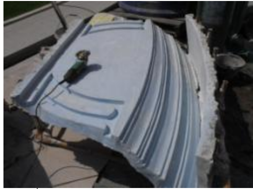
ภาพที่ ง.97 การแสดงแบบหล่อโดยใช้ปูนปลาสเตอร์ผสมไฟเบอร์ที่ผิวด้านนอก
