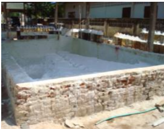
ภาพที่ ซ.9 การแสดงบ่อปูนหมักร้อนแยกปูนผงลงไปหมักในบ่อหมักให้น้ำท่วมปูนหมักอย่างน้อย 5 เซนติเมตร
