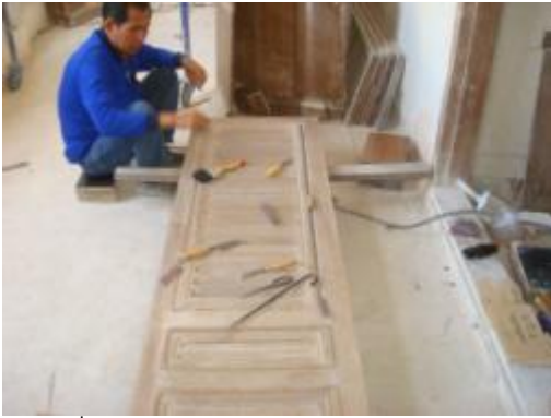
ภาพที่ ข.1 การแสดงขัดผิวไม้และซ่อม ตกแต่งให้เรียบร้อย
