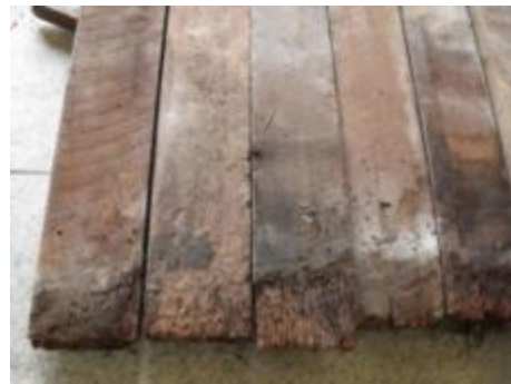
ภาพที่ 5.10 การแสดงความเสียหายของแผ่นพื้นไม้กระดานที่สัมผัสกับความชื้น
