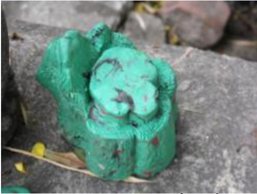
ภาพที่ ง.130 การแสดงใช้ดินน้ำมันปั้นเป็นแบบเพื่อทำแม่พิมพ์โพลีเอทิลีนหรือใช้ยางพาราเป็นแบบหล่อ
