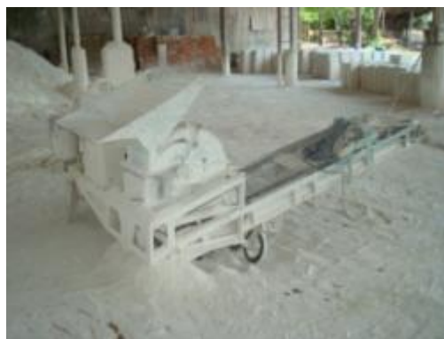
ภาพที่ ซ.6 การแสดงเครื่องบดโมหินปูนที่เผา สุกแล้วด้วยมอเตอร์ไฟฟ้า
