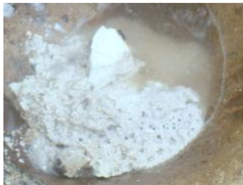
ภาพที่ ซ.5 การแสดงหินปูนที่เผาเสร็จ เรียบร้อยแล้วเป็นปูนสุกแตกตัวเป็นผงปน เมื่อแช่น้ำ
