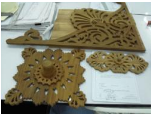
ภาพที่ ฉ.148 การแสดงไม้ฉลุใหม่เพื่อใช้ทดแทนไม้เดิมที่เสียหาย
