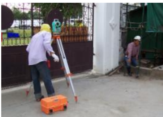
ภาพที่ ข.3 การแสดงกล้องวัดมุมและระยะ เพื่อใช้วัดค่าพิกัดตำแหน่งของอาคารโบราณสถาน
