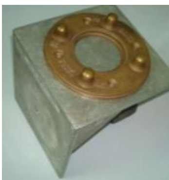
ภาพที่ 2.13 การแสดงอุปกรณ์ Tiltmeter ส่วนที่ยึดติดกับตัวอาคาร
