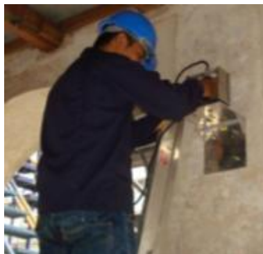
ภาพที่ 2.16 การแสดงอุปกรณ์ Tiltmeter ขณะวัดค่าการเอียงตัวของอาคารโบราณสถานพระราชวังสรามุรรมย์
