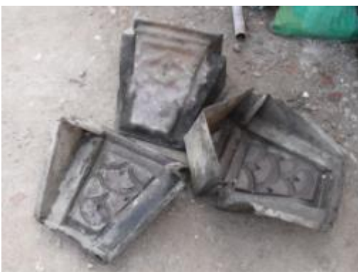
ภาพที่ ง.96 การแสดงแบบหล่อปูนปั้นสำเร็จโดยใช้ไฟเบอร์กลาส
