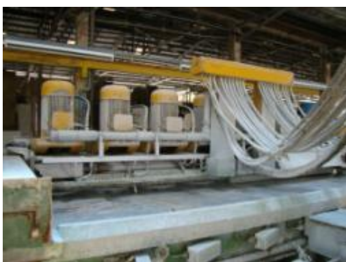
ภาพที่ จ.46 การแสดงเครื่องขัดผิวหินอ่อนในโรงงานหินอ่อน
