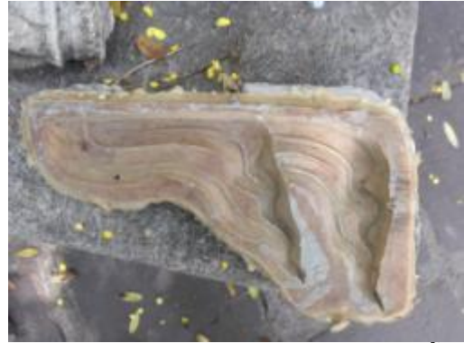
ภาพที่ ง.132 การแสดงแบบหล่อบัวปูนปั้นทำจากยางพารา
