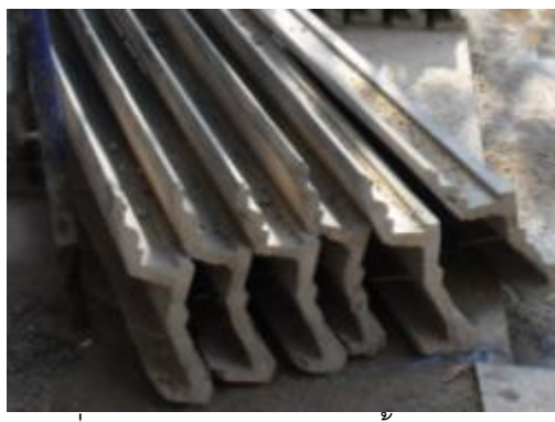
ภาพที่ ง.93 การแสดงบัวปูนปั้นหล่อสำเร็จ เตรียมติดตั้งบนอาคาร
