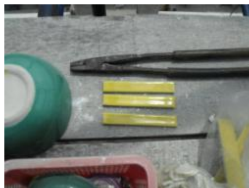
ภาพที่ ๑.69 การแสดงชิ้นส่วนกระเบื้องเคลือบและคีมเหล็กที่ใช้ตัดแต่งขอบเศษกระเบื้องเคลือบประดับผนังอาคาร
