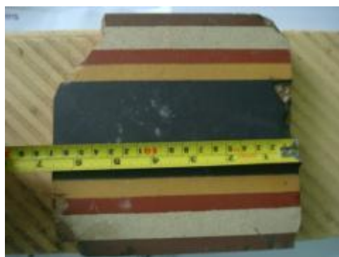
ภาพที่ 5.40 การแสดงตัวอย่างกระเบื้องปูพื้นเดิมที่หลงเหลืออยู่เล็กน้อยใช้เป็นตัวอย่างผลิตใหม่เลียนแบบกระเบื้องเดิม
