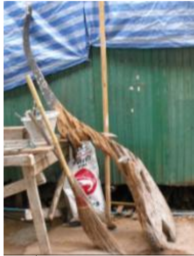
ภาพที่ ๑.46 การแสดงข้อฟ้าผุเสียหายมาก
