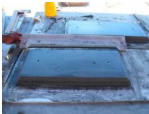
ภาพที่ ง.91 การแสดงใช้แผ่นอะคริลิคทำ ขอบบัวปูนปั้นเพื่อใช้ติดตั้งผนังอาคาร
