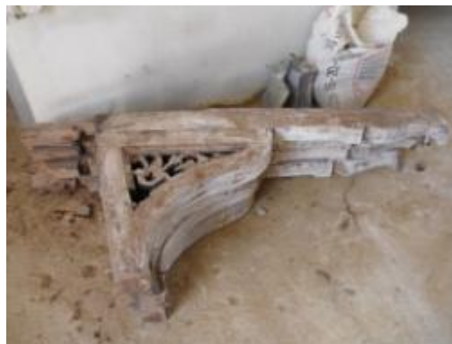
ภาพที่ 6.16 การแสดงจันทันไม้ผุเสียหายจากความชื้น
