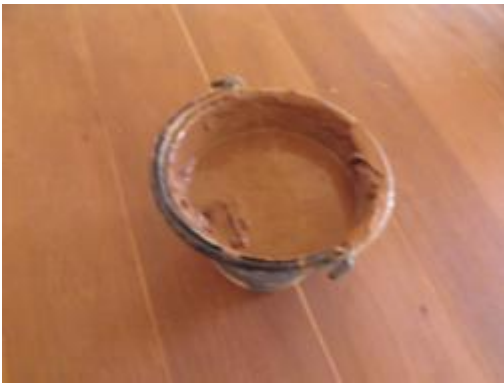
ภาพที่ ๑.6 การแสดงดินสอพองผสมสีใช้อุด ปิดตามผิวและร่องไม้
