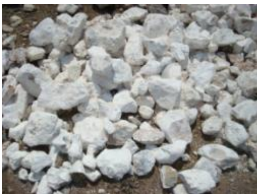
ภาพที่ ซ.4 การแสดงหินปูนที่เผาเสร็จมีสีขาว เพิ่มมากขึ้นและมีน้ำหนักเบาขึ้น
