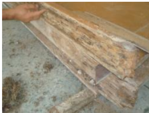
ภาพที่ 7.27 การแสดงวงกบไม้เสียหายเนื่องจากปลวกกัดกิน
