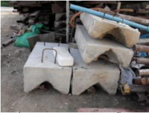
ภาพที่ ง.94 การแสดงแบบหล่อปูนปั้นโดยใช้คอนกรีตเป็นแบบหล่อ
