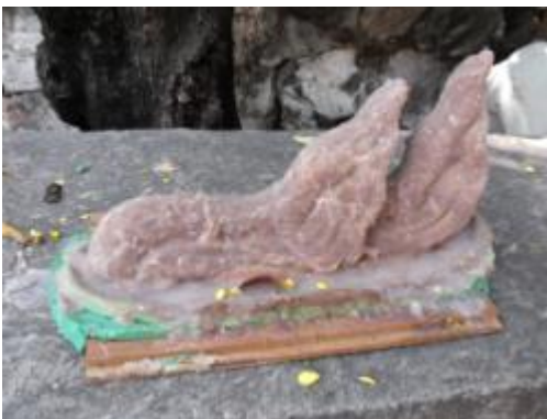
ภาพที่ ง.131 การแสดงแบบหล่อบัวปูนปั้นทำจากยางพารา
