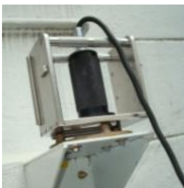
ภาพที่ 2.14 การแสดง อุปกรณ์ Tiltmeter ขณะวัดค่าการเอียงตัวของอาคาร
