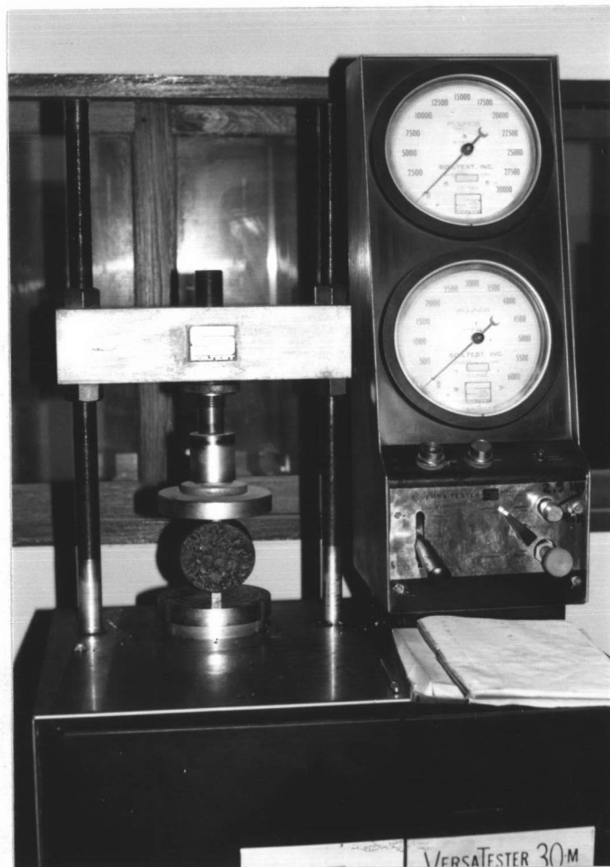
รูปที่ 4.4 การทดลองหาค่าแรงดึงทางอ้อม
