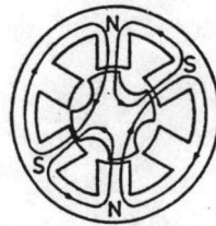
(ก) แสดงเส้นทางเดินของเส้นแรงแม่เหล็กในการกระตุ้นแบบเฟสคู่
