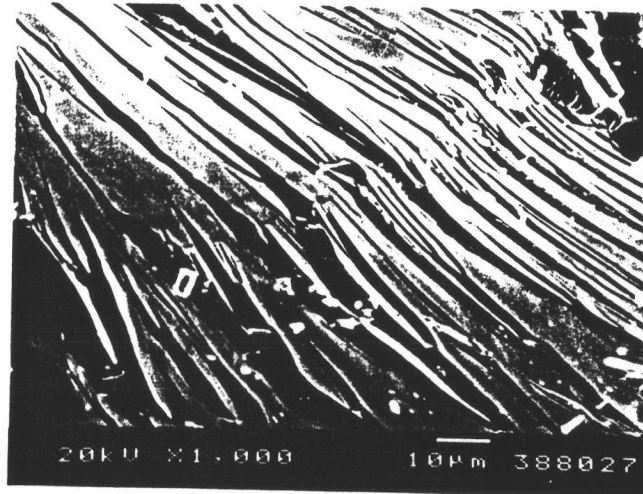
รูปที่ 2.29 ภาพสภาพผิวหน้าของผลึกกิ่งตัวนำ CISA6 ที่มีการซ้อนกัน ของระนาบเล็กๆ ถ่ายจากกล้องจุลทรรศน์อิเล็กตรอน
