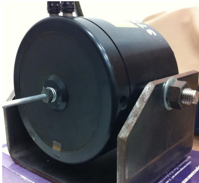
รูปที่ 4.27 เครื่องกำเนิดแรงสั่นสะเทือน (Vibration exciter)
