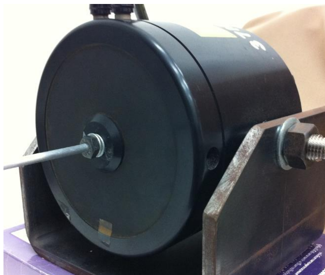
รูปที่ ข-3 เครื่องกำเนิดการสั่นสะเทือน B&K รุ่น 4809
