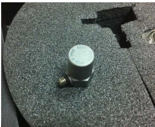
รูปที่ ข-7 ทหรานส์ดิวเซอร์แบบวัดความเร่ง B&K DeltaTron รุ่น 4397A
