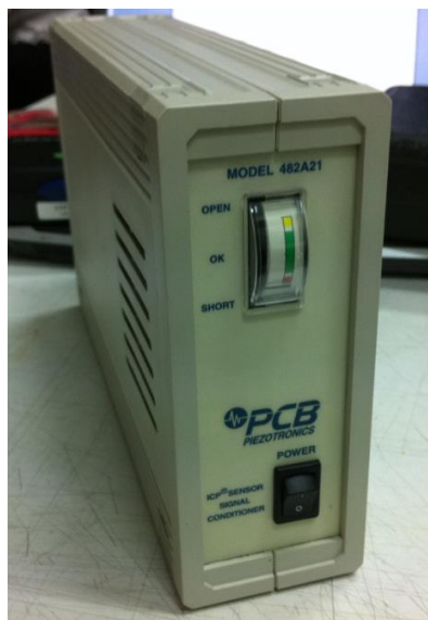
รูปที่ ข-2 เครื่องขยายสัญญาณ Piezotronics รุ่น 482A21
