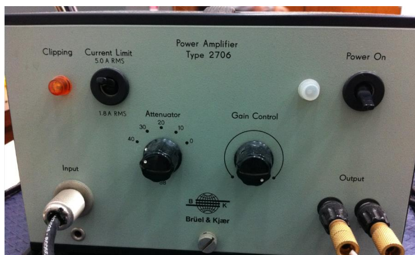
รูปที่ ข-4 Power amplifier B&K รุ่น 2706
