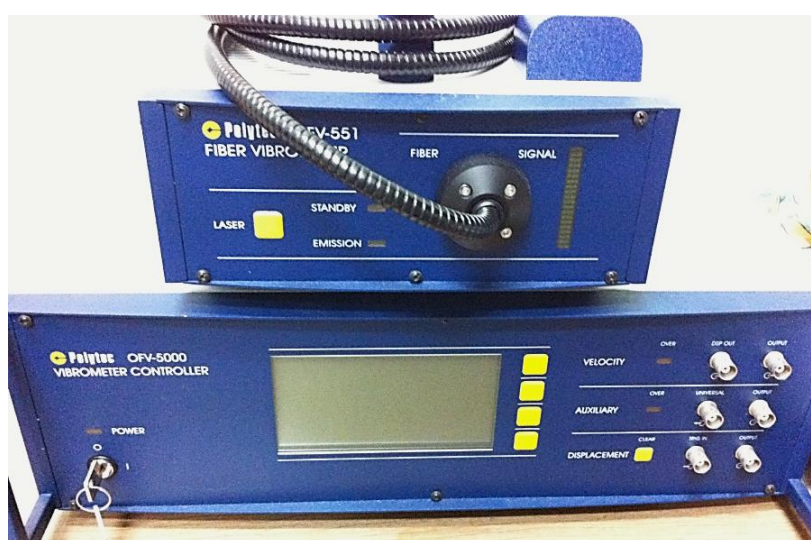
รูปที่ ข-8 เครื่องยิงเลเซอร์ของ Polytec รุ่น OFV-551 และเครื่องควบคุมสัญญาณของ Polytec รุ่น OFV-5000
