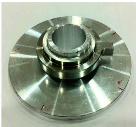
รูปที่ 4.7 ชุดแบบจำลองของสปินเดิลมอเตอร์หลังประกอบส่วนประกอบทั้งสองเข้าด้วยกัน
