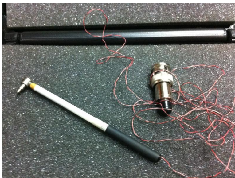
รูปที่ ข-1 ค้อนเคาะ Piezotronics รุ่น 086D80
