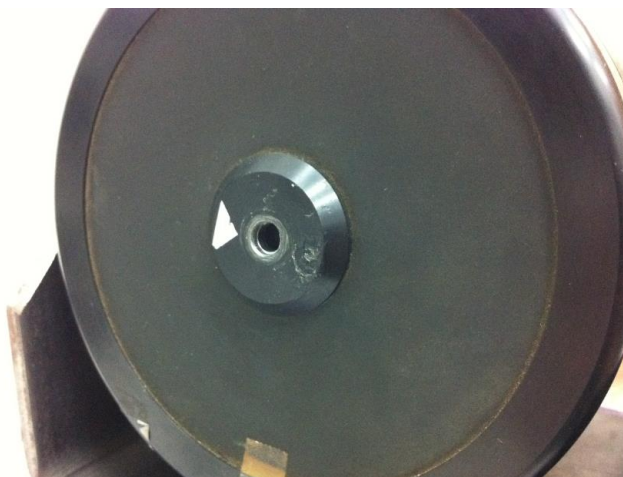
รูปที่ ข-5 จานสั่นสะเทือนหรือส่วนเคลื่อนที่ที่จะนำแท่งส่งผ่านแรงสั่นสะเทือนมาสวม
