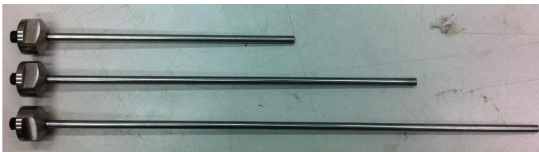
รูปที่ ข-6 แท่งส่งผ่านแรงสั่นสะเทือนเมื่อผลิตเสร็จ
