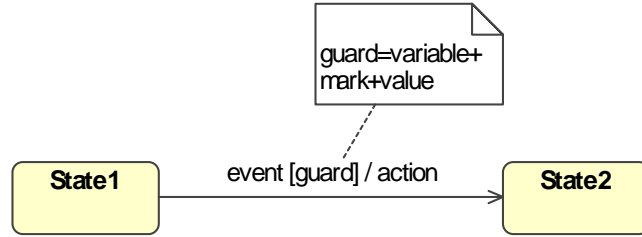
รูปที่ 3.62 ลักษณะของเงื่อนไขในแผนภาพสเตตชาร์ท
