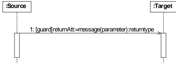
รูปที่ 3.36 รูปแบบของเมสเสจในแผนภาพซีควเอนซ์
