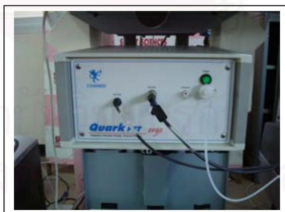
รูปที่ 8 อุปกรณ์ประมวลผลการวิเคราะห์การแลกเปลี่ยนก๊าซ
