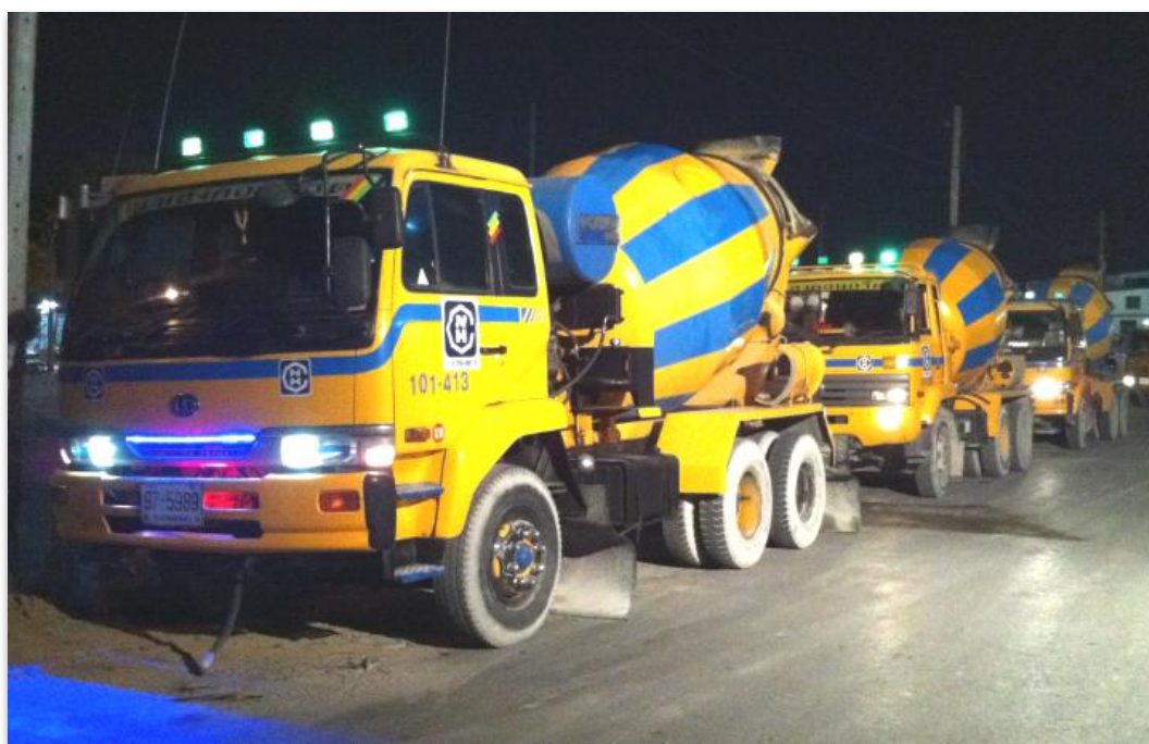
ภาพที่ 3-12 ชนิดรถที่ใช้ขนส่งคอนกรีต (ผสมเสร็จ)
