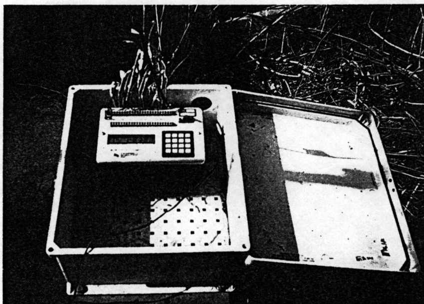
รูปที่ 21 เครื่องมือเก็บข้อมูล Cambel Scientific Data Logger พร้อมสายวัดอุณหภูมิ Thermo Couple Type "J"
