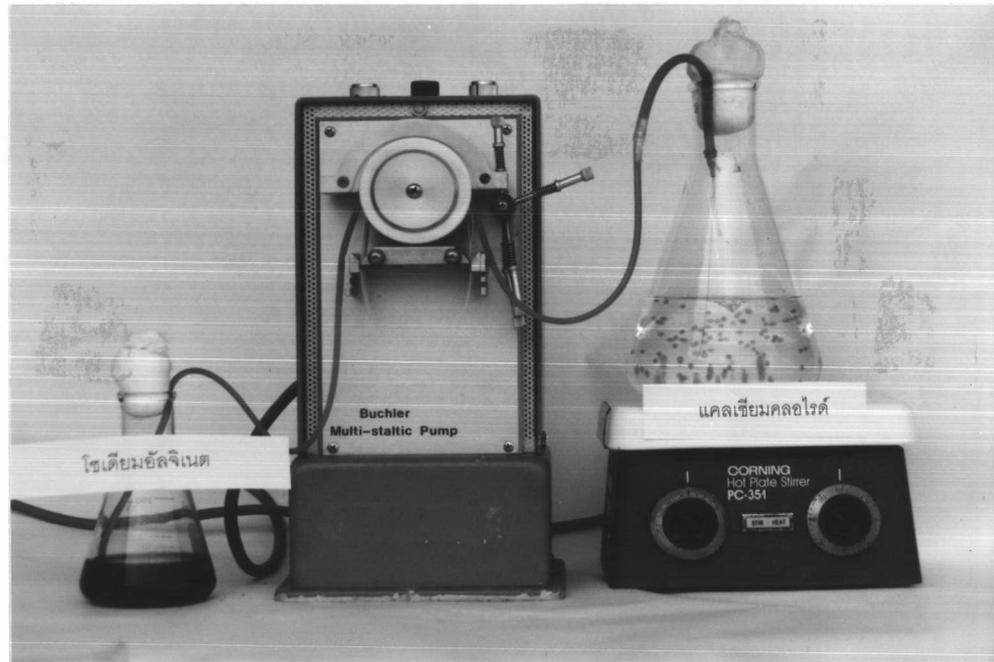
รูปที่ 2 การตรึงสปอร์ *Aspergillus* sp.G153 ในแคลเซียมอัลจิเนต
