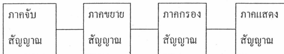
รูปที่ 2.1 ขั้นตอนการตรวจวัดค่า electromyogram (EMG)
