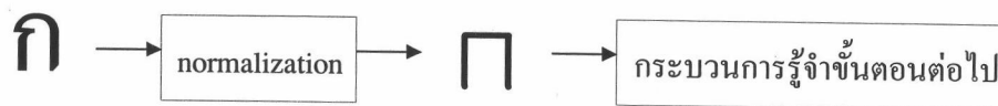
รูปที่ 5.1 แสดงการแปลงภาพตัวอักษรให้อยู่ในรูปแบบโครงสร้างอย่างง่าย
