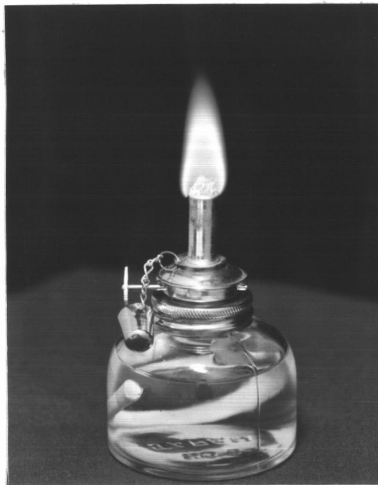
รูปที่ 19 แสดงถึงตะเกียงซึ่งใช้ในการทำกรรมวิธีผ่านความร้อนโดยเปลวไฟ
