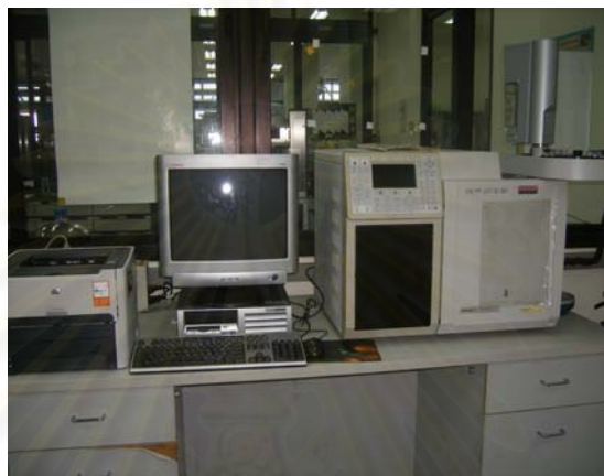
รูปที่ 3.7 เครื่องแก๊สโครมาโทกราฟี (Gas chromatograph) ยี่ห้อ Varian รุ่น CP-3800
