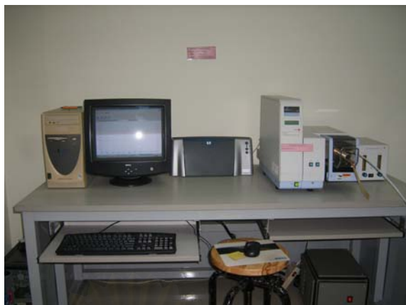
รูปที่ 3.6 เครื่อง Thermal analyzer รุ่น Pyris Diamon ของ PerkinElmer
