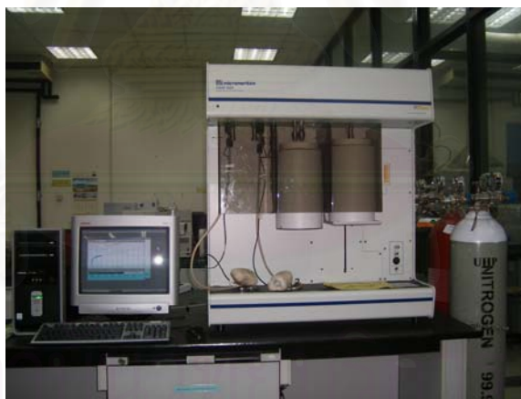
รูปที่ 3.4 เครื่อง Surface area and porosity analyzer รุ่น ASAP 2020 ยี่ห้อ Micromeritic
