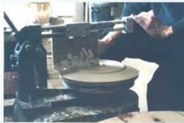
รูปที่ 3.22 การขึ้นรูปด้วยเครื่องจิกเกอร์
