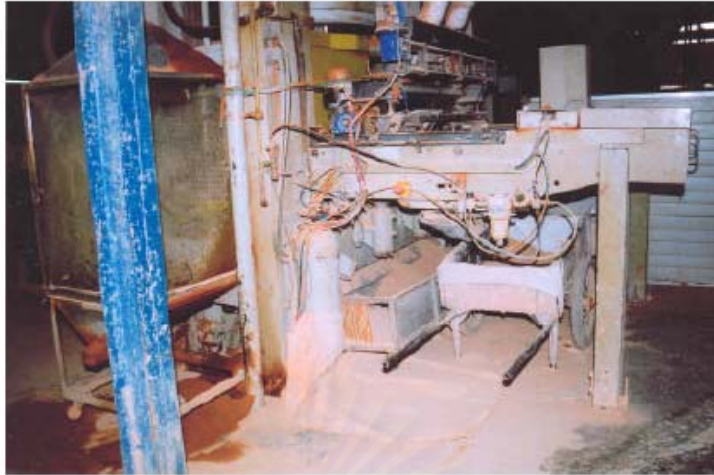
รูปที่ 2.5 การใช้อุปกรณ์รองวัตถุดิบตกหล่นเพื่อลดปริมาณวัตถุดิบที่ปนเปื้อน
