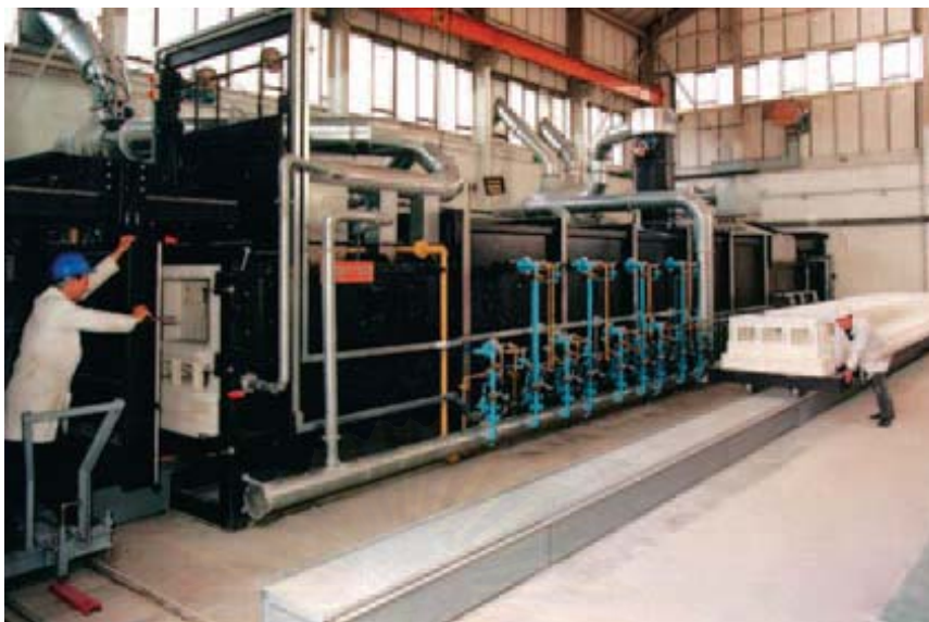
รูปที่ ข. 9 ตัวอย่างเตาที่ใช้พลังงานไมโครเวฟช่วยในการเผา
