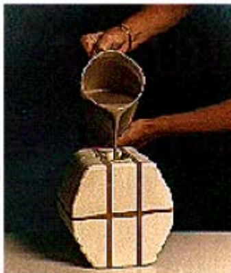
รูปที่ 3.16 การเทน้ำดินใส่พิมพ์ปูนปลาสเตอร์
