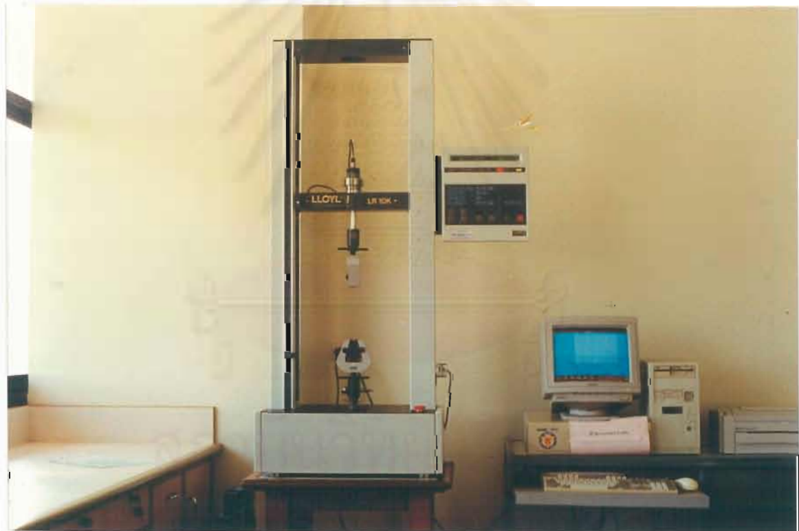
รูปที่ 11 เครื่องยูนิเวอร์แซลเทสติงมาชีน (Lloyd Universal Testing Machine, Model LR 10 K)
