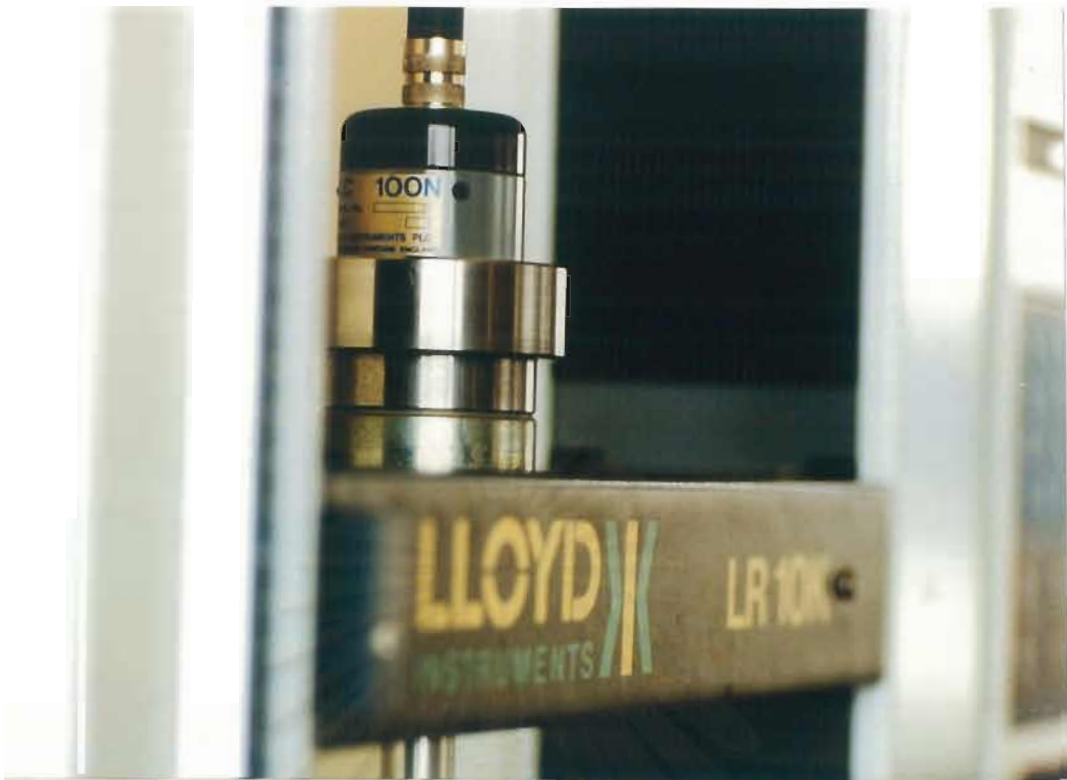
รูปที่ 14 ต้มน้ำหนัก (Load cell) ขนาด 100 นิวตัน
