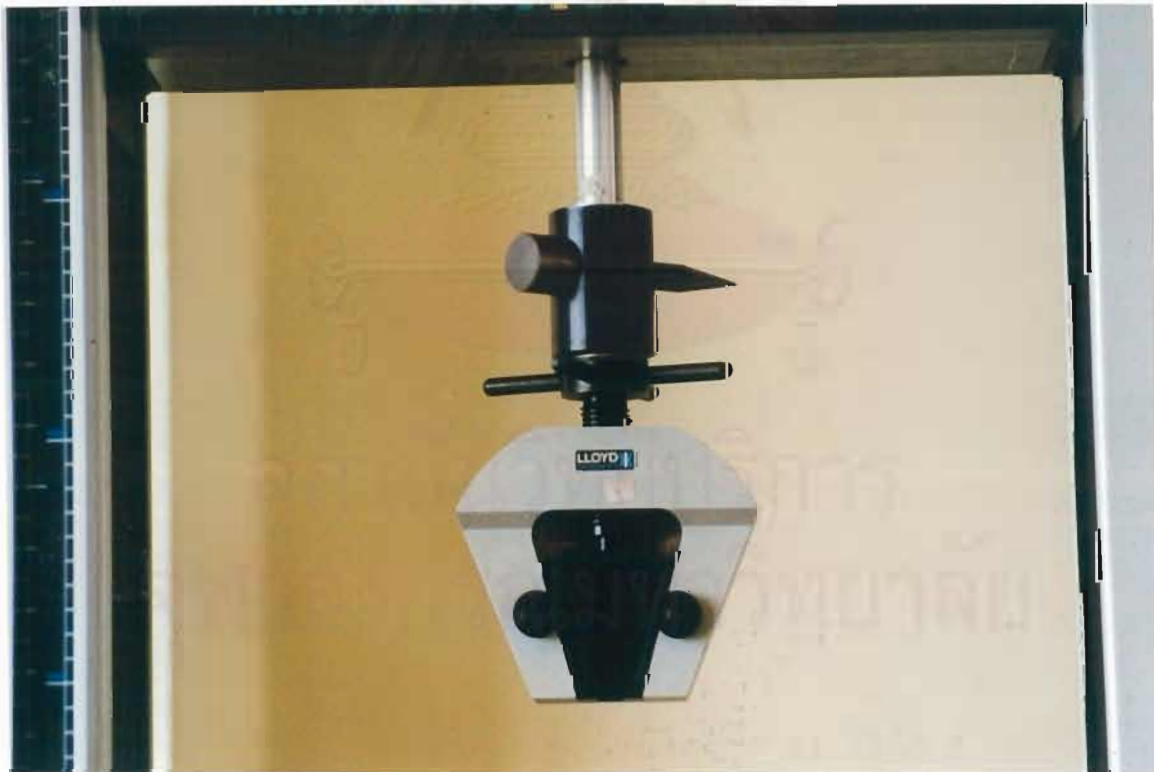
รูปที่ 13 ครอสเซค และนิวเมติกกริป (สำหรับยึดเครื่องมือจับยึดแบรกกเกต)
