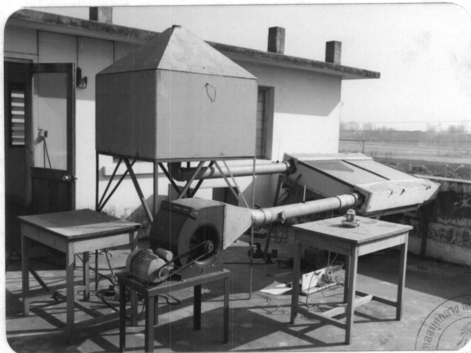
รูปที่ 3.1 เครื่องอบข้าวเปลือกพลังงานแสงอาทิตย์ที่ใช้ในการทดลอง
