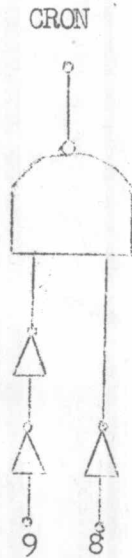
รูปที่ ๗ วงจรลอจิกที่ใช้ควบคุมการส่งข้อมูลเมื่อใช้ NAND GATE
