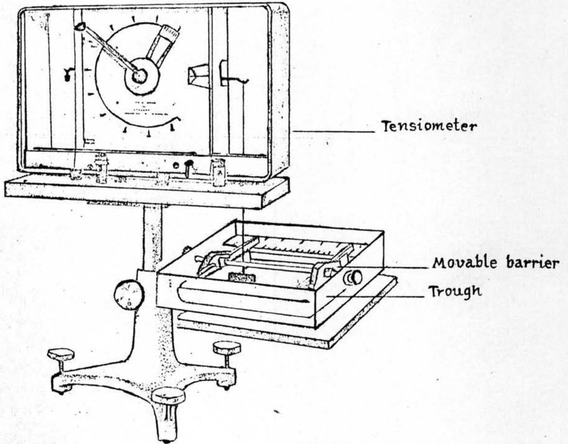
รูปที่ 14 เครื่องมือวัดแรงตึงผิวพร้อมด้วยถาดและที่กั้นซึ่งเคลื่อนที่ได้ (46)
