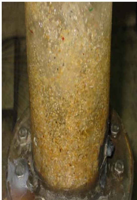
รูปที่ 4.3 การเกิดฟลูอิดไดซ์แบบ bubbling fluidization
