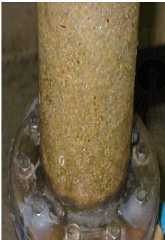
รูปที่ 4.2 การเกิดฟลูอิดไดซ์แบบ smooth fluidization
