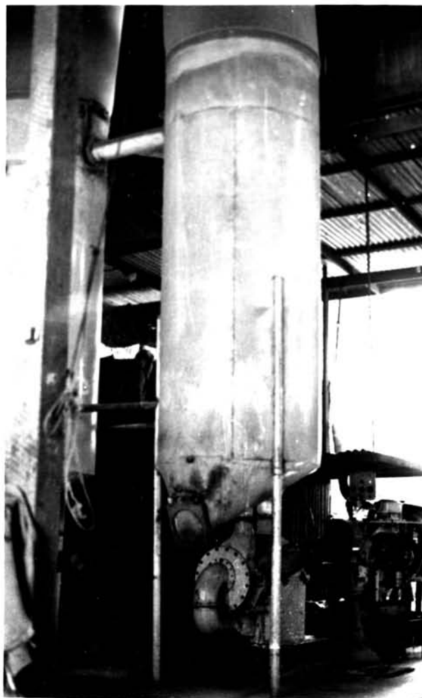
รูปที่ 11 แสดงให้เห็นเครื่องมือ เครื่องยนต์ดูด พัดลมดูด ดึงเก็บและนำกรอง
