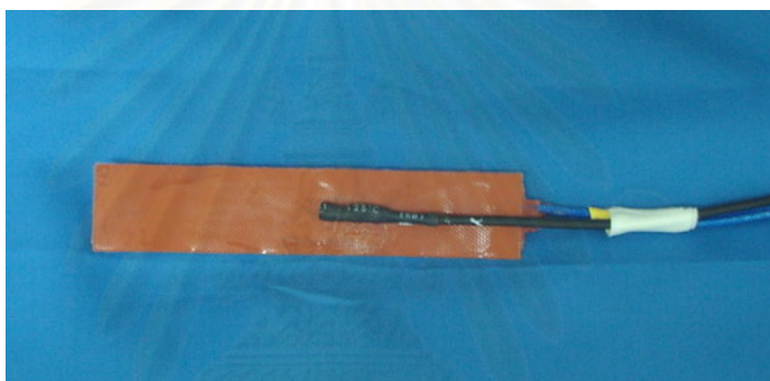
ภาพที่ 5 แถบซิลิโคนให้ความร้อน และตัววัดอุณหภูมิ
