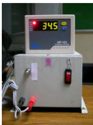
ภาพที่ 6 ส่วนควบคุมอุณหภูมิโดยมีปุ่มปรับกระแสไฟฟ้า และจอแสดงผลแบบดิจิตอล
