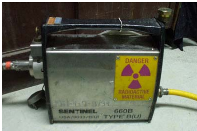
รูปที่ 3.3 โปรเจกเตอร์บริจูดิเทียม-192 สำหรับการถ่ายภาพด้วยรังสีแกมมา
