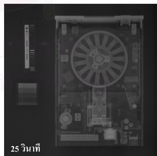
รูปที่ 4.10 ภาพถ่ายชิ้นงานจากแผ่นบันทึกภาพนิวตรอนที่ระยะ 120 ซม. โดยใช้เวลาในการถ่ายภาพ ต่างๆ
