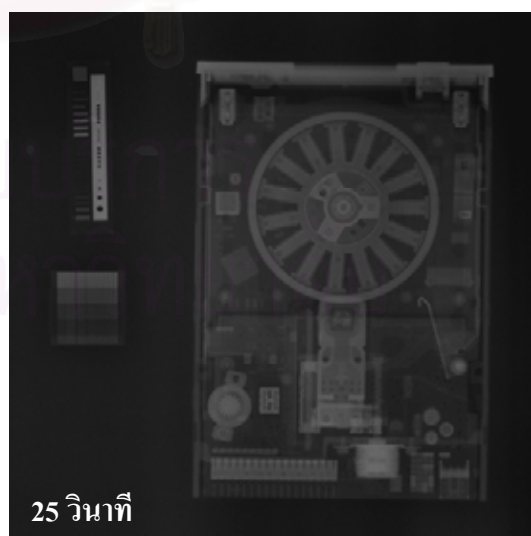
รูปที่ 4.9 ภาพถ่ายชิ้นงานจากแผ่นบันทึกภาพนิวตรอนที่ระยะ 100 ซม. โดยใช้เวลาในการถ่ายภาพ ต่างๆ
