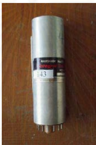
รูปที่ 3.13 หัววัดรังสีโซเดียมไอโอไดค์ (ชำรุด)
