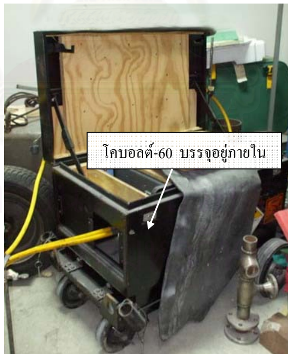
รูปที่ 3.2 โปรเจกเตอร์บรรจุโคบอลต์-60 สำหรับการถ่ายภาพด้วยรังสีแกมมา
